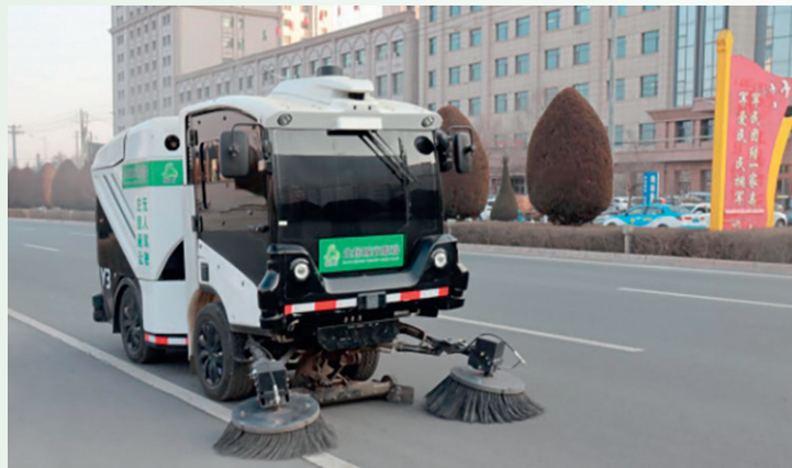
大型無人清掃車輛作業現場
